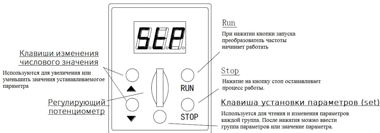
Примечание: питание инвертора на задней панели дисплея STP (замкнуто для готовности запуска ) или ВЫКЛ (разомкнуто, нет готовности).
