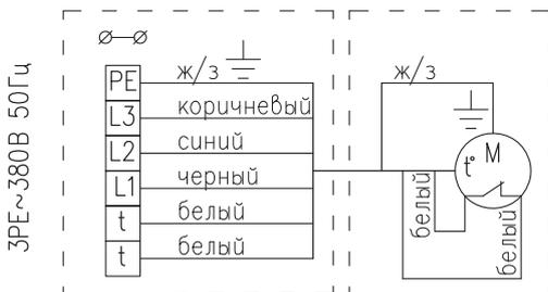
Подключение к сети 380 В 50 Гц по схеме "Звезда"
