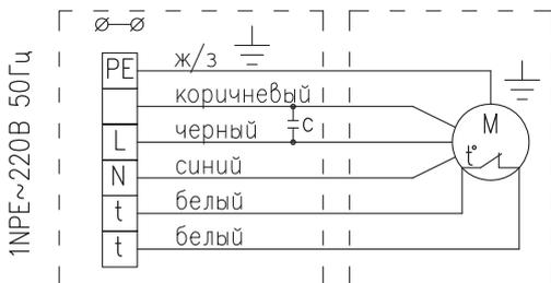
Схема Б. Подключение к сети 220 В 50 Гц
