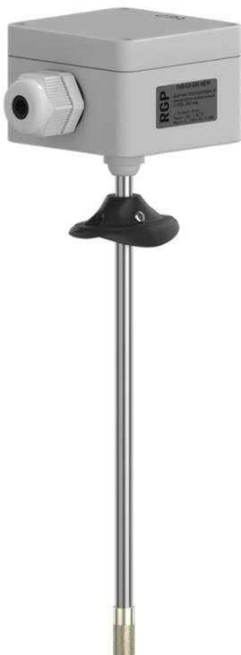
Канальный преобразователь температуры и влажности THS-02 с длиной измерительной трубки 100, 240 и 340 мм. измеряет температуру и относительную влажность воздуха посредством измерительного элемента компании Silicon Labs.
