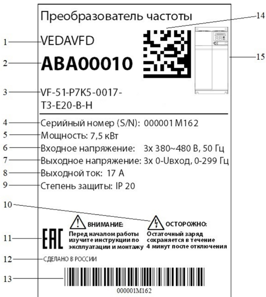
Рис. 1-3. Пример маркировки преобразователя частоты
